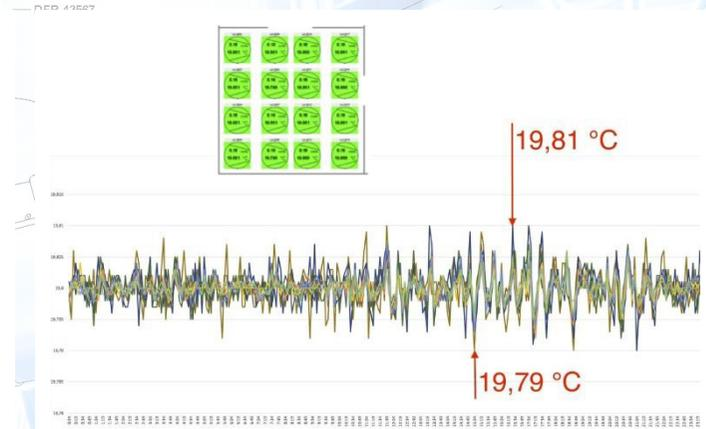
Messdaten der Temperaturkonstanz-Aufzeichnung: Raumtemperatur mit Filter Fan Units
